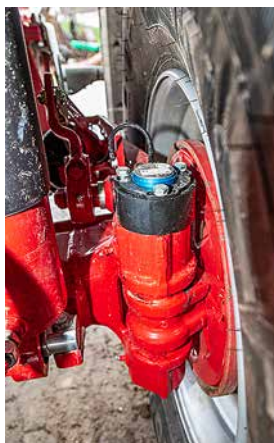
Die Hydac-Lenkung besteht aus einer separaten Steuerbox, einem Loadensing-Block und einem kleinen Inertialsensor.
