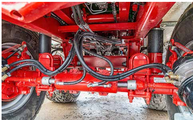
Die elektro-hydraulische Zwangslenkung erfordert Sensoren zur Geschwindigkeits-, Fahrtrichtungs- und Lenkerkennung.
