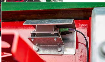
Die Hydac-Lenkung besteht aus einer separaten Steuerbox, einem Loadensing-Block und einem kleinen Inertialsensor.
