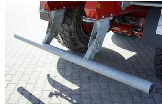
Mechanisch klappbarer Unterfahrschutz
