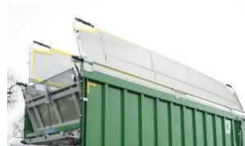
Zweiflügeliges, hydraulisches Abdecksystem
