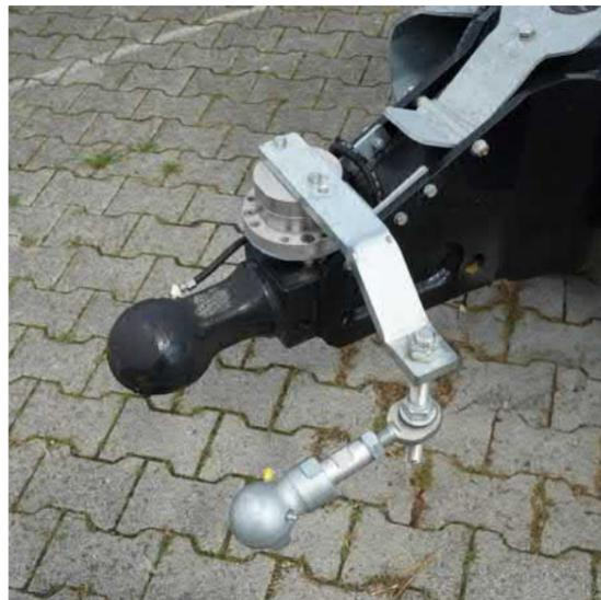
**DIE ELEKTRO-HYDRAULISCHE ZWANGSLENKUNG**
