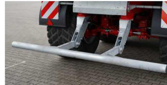
Hydraulisch klappbarer Unterfahrschutz
