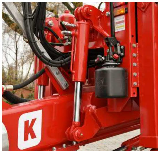
Die hydraulische Deichselverstellung ermöglicht eine stufenlose Anpassung an unterschiedliche Ankuppelhöhen. Durch den integrierten Stickstoffspeicher werden Stöße im Fahrbetrieb wirkungsvoll gedämpft.
