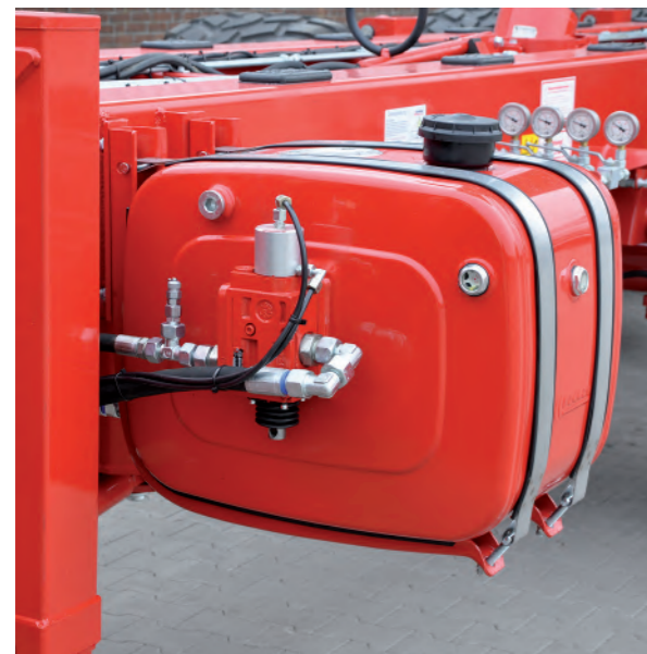
Der Hydrauliktank (eigene Ölversorgung)
