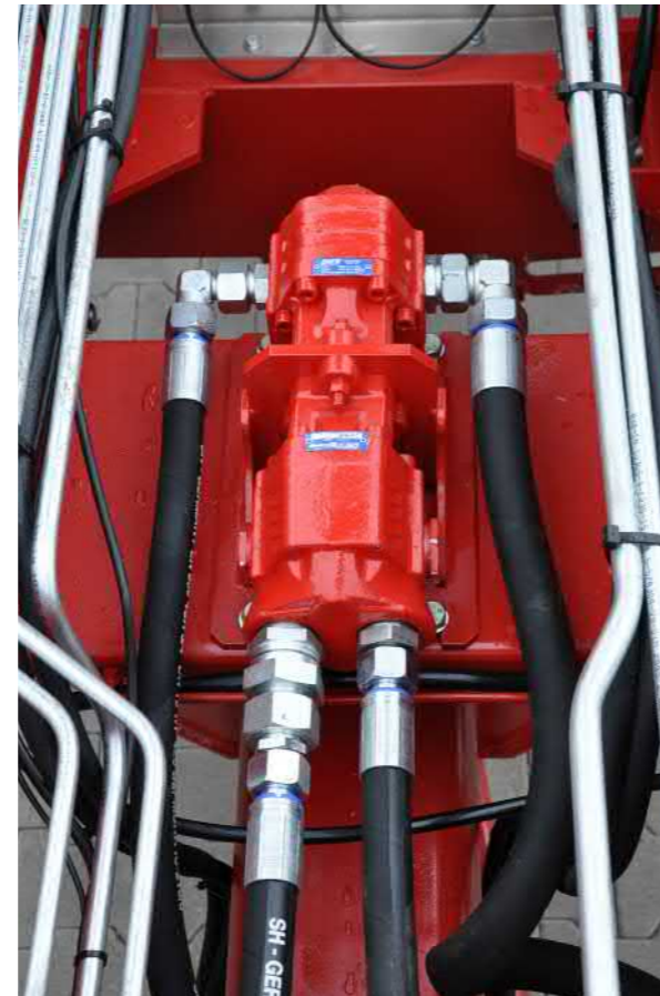
Hydraulikpumpe über einen Ölmotor angetrieben.
