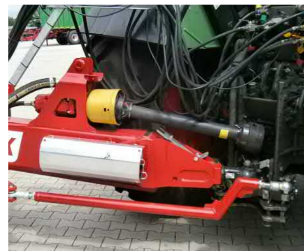
Die Hydraulikpumpe über die Zapfwelle angetrieben.
