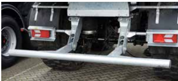
Hydraulische beschermingsinrichting tegen klemrijden
