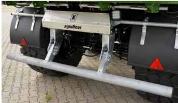
Mechanisch inklapbare beschermingsinrichting tegen klemrijden
